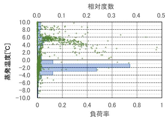
図 3 冷房時の負荷率と蒸発温度の関係
