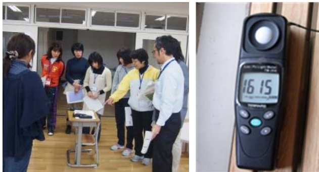
図 3-74 教職員が教室の照度を測定している様子(左写真)と照度計(右写真)
