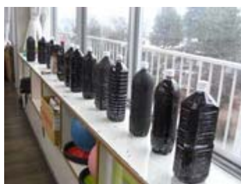
図 3-82 太陽熱でお湯ができる仕組みを確かめる実験(例)
