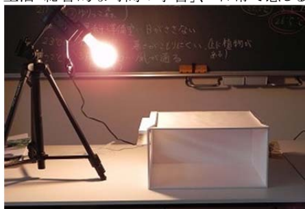
図 3-33 ライトシェルフの仕組みを説明する模型(例)
