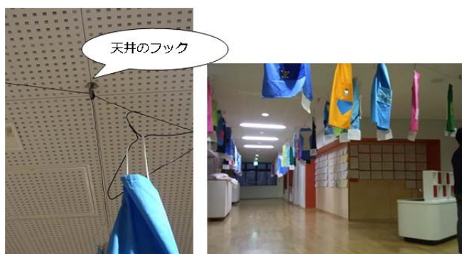
図 3-44 校舎内の風の流れの可視化方法(例)
