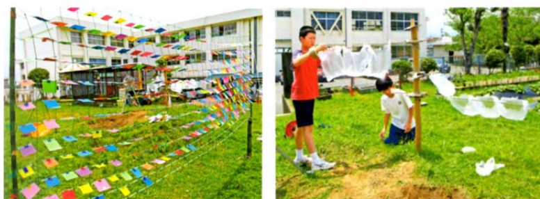
図 3-45 屋外の空気の動きの可視化方法(例)
